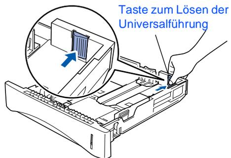
Taste zum Lösen der Universalführung
