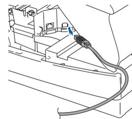
3. Führen Sie das Kabel - wie gezeigt - vorsichtig durch die Vertiefung zur Rückseite des MFC.
