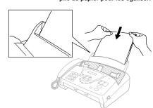
Branchez le combiné (FAX-T94, FAX-T96 uniquement), le cordon d'alimentation et le câble de raccordement à la
