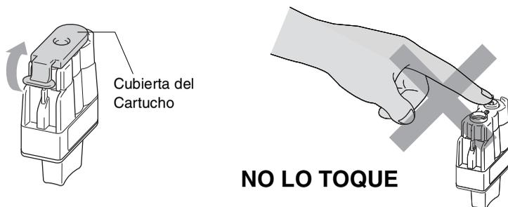
⊘ No toque el área que se muestra en la ilustración de abajo.
