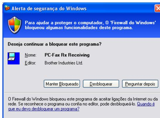
O software de recepção PC-FAX da Brother permite-lhe visualizar e guardar os seus faxes no computador. É instalado automaticamente quando instala o MFL -Pro Suite e funciona em equipamento local ou de rede. Quando esta opção estiver activada, o aparelho receberá faxes na respectiva memória. O fax, depois de recebido, será automaticamente enviado para o computador.
