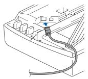
10 Guidez soigneusement le câble réseau dans la rainure comme indiqué ci-dessous, en suivant celle-ci autour et vers l'arrière de l'appareil. Connectez ensuite le câble au réseau.
