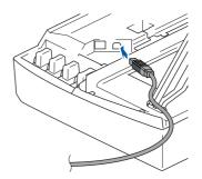
**12** Guidez soigneusement le câble USB dans la rainure comme indiqué ci-dessous, en suivant celle-ci autour et vers l'arrière de l'appareil.
