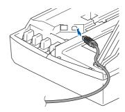
Guidez soigneusement le câble USB dans la rainure comme indiqué ci-dessous, en suivant celle-ci autour et vers l'arrière de l'appareil. Connectez ensuite le câble au Macintosh<sup>®</sup>.
