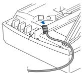
Guidez soigneusement le câble réseau dans la rainure comme indiqué ci-dessous, en suivant celle-ci autour et vers l'arrière de l'appareil. Connectez ensuite le câble au réseau.
