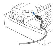
10 Guidez soigneusement le câble USB dans la rainure comme indiqué ci-dessous, en suivant celle-ci autour et vers l'arrière de l'appareil.
