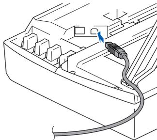
**10** Führen Sie das Kabel - wie gezeigt - vorsichtig durch die Vertiefung zur Rückseite des MFC.
