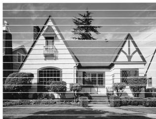
Quando uma saída da cabeça de impressão estiver bloqueada, a amostra imprimida assemelha-se a isto.
