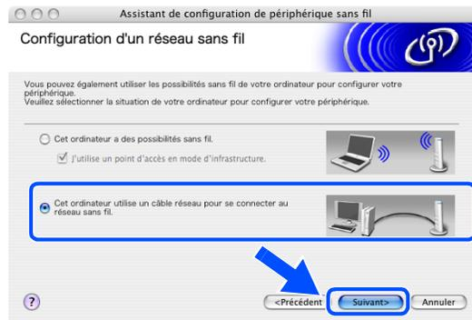
**12** Suivez les instructions qui s'affichent à l'écran pour terminer l'installation à l'aide du panneau de commande. Voir *Utilisation de l'assistant de configuration du menu Réseau du panneau de commande pour un réseau sans fil* page 3-3. Ensuite, passez à l'installation du pilote à l'étape 20.
