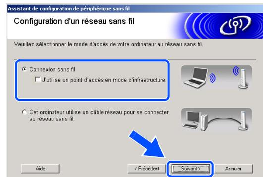
Si vous utilisez un ordinateur câblé, sélectionnez **Cet ordinateur utilise un câble réseau pour se connecter au réseau sans fil.** et configurez le réseau sans fil à partir du panneau de commande. Cliquez sur **Suivant** et suivez les instructions qui s'affichent à l'écran pour terminer l'installation. Voir *Configuration de votre appareil pour un réseau sans fil* page 3-3. Ensuite, passez à l'installation du pilote à l'étape **19**.
