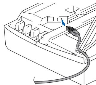
**10** Inserte con cuidado el cable USB en la ranura, como se indica a continuación, pasando del círculo de ranura de conexión hacia la parte trasera del equipo.
