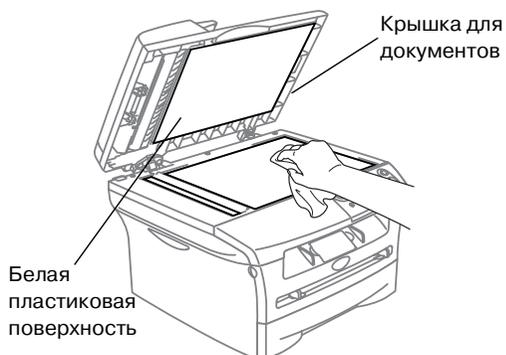
В автоматическом устройстве подачи документа очистите белую пластиковую планку и стеклянную полосу сканера под пленкой не оставляющей ворса мягкой тряпкой, смоченной изопропиловым спиртом.
