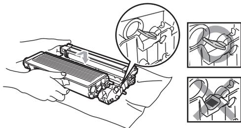
7 Nettoyez le fil corona principal à l'intérieur du tambour en faisant coulisser délicatement la languette bleue de gauche à droite à plusieurs reprises. N'oubliez pas de ramener la languette bleue à sa position d'origine (▼).
