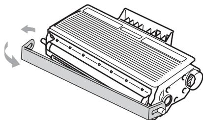
6 Mettez fermement en place la nouvelle cartouche de toner dans le tambour jusqu'à ce que vous entendiez un déclic. Si vous l'installez correctement, le levier de verrouillage se soulève automatiquement.
