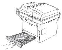
2 Вытяните замятую бумагу из машины или лотка для двусторонней печати.
