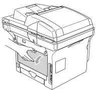
Потяните рычаги слева и справа к себе для открытия крышки блока термического закрепления тонера (1).
