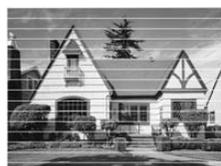
In caso di ostruzione di un ugello delle testine di stampa, la prova di stampa appare in questo modo.
