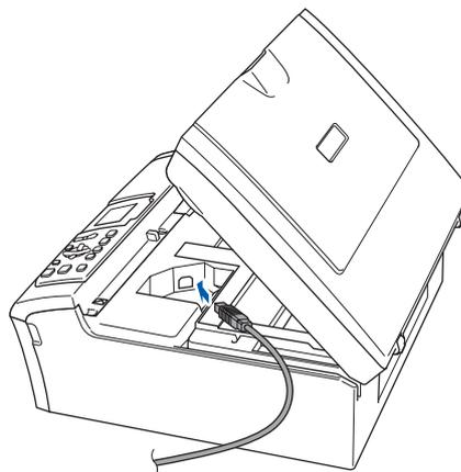
**12** 如下图所示，小心地将USB接口电缆嵌入槽内，并顺着槽绕到设备后部。然后将接口电缆连接到您的计算机上。
