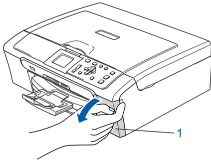
3 Empurre para baixo os manípulos de libertação do encaixe e retire a peça de protecção amarela (1).
