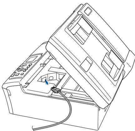
**4** Inserte con cuidado el cable de red en la ranura, como se indica a continuación, pasando del círculo de ranura de conexión hacia la parte trasera del equipo. A continuación, conecte el cable a la red.
