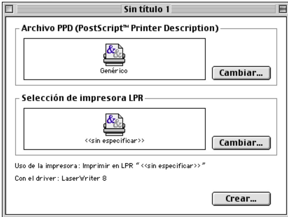
**Figura 4 Selección del PPD y la configuración LPR**
