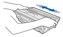
Setzen Sie die Trommeleinheit in den Drucker ein.
