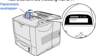
Drücken Sie die Go-Taste. Der Drucker druckt nun eine Testseite aus. Prüfen Sie, ob diese Testseite korrekt gedruckt wurde.
