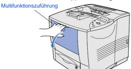
Entfernen Sie die Transportsicherung aus der Multifunktionszuführung.
