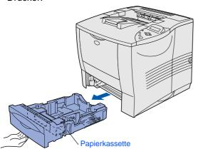
2 Entfernen Sie die Transportsicherung aus der Papierkassette.
