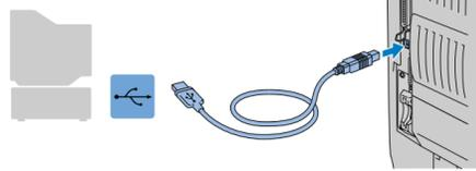
6 Conecte el cable de interfaz USB al PC y, a continuación, conéctelo a la impresora. **Para Windows® 98/Me usuarios: La configuración habrá finalizado. Para Windows® 2000 usuarios: Ir al paso 7.**
