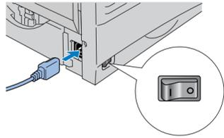
1 Asegúrese de que el interruptor de alimentación de la impresora esté desconectado. Conecte el cable de alimentación de CA a la impresora. **No conecte el cable de interfaz.**
