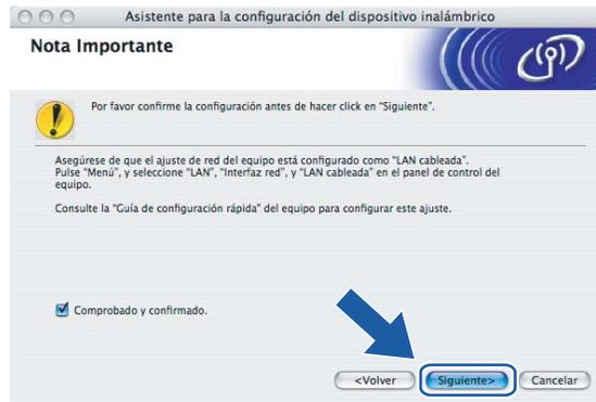
**8** Conecte el dispositivo inalámbrico Brother a su punto de acceso mediante un cable de red y haga clic en **Siguiente**. Vaya al paso **13**.
