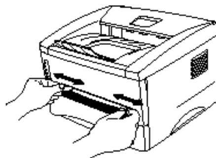
5. Introduzca el sobre en la ranura de alimentación manual utilizando ambas manos hasta que el borde de la transparencia contacte con el rodillo de alimentación de papel. Mantenga la transparencia en esa posición hasta que la impresora la introduzca de forma automática una pequeña distancia y, a continuación, suelte la transparencia.
