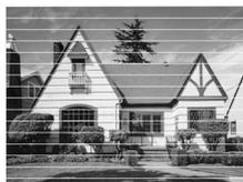
Lorsqu'une buse de tête d'impression est colmatée, voici à quoi ressemble la sortie imprimée.
