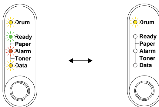
Fig. 4-2 Indicazioni visive dei LED per errore di funzionamento dell'unità di fusione
