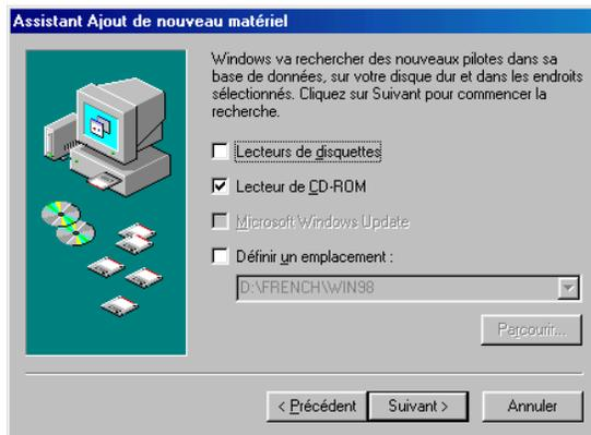
6. Cliquez sur le bouton **Suivant**. Le pilote USB est alors installé.
