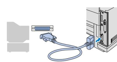
2 Schließen Sie das Parallelkabel an den PC und dann an den Drucker an.
