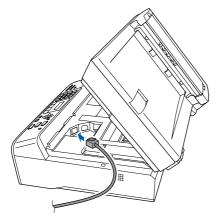
Inserire accuratamente il cavo di rete nella canalina come mostrato di seguito, disponendo il cavo intorno e verso il lato posteriore dell'apparecchio.
