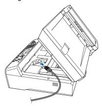
Inserire accuratamente il cavo USB nella canalina come mostrato di seguito, disponendo il cavo intorno e verso il lato posteriore dell'apparecchio. Quindi, collegare il cavo alla rete
