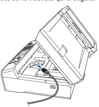
12 Inserire accuratamente il cavo USB nella canalina come mostrato di seguito, disponendo il cavo intorno e verso il lato posteriore dell'apparecchio. Quindi, collegare il cavo alla rete.
