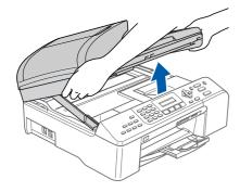
2 Collegare il cavo USB al connettore USB contrassegnato con il simbolo ←. Il connettore USB si trova all'interno dell'apparecchio sulla destra, come illustrato qui di seguito.
