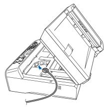
Inserire accuratamente il cavo di rete nella canalina come mostrato di seguito, disponendo il cavo intorno e verso il lato posteriore dell'apparecchio.
