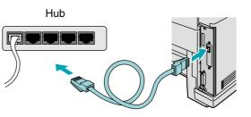
2 Conecte un extremo del cable de red a la impresora y conecte el otro extremo a un puerto libre del concentrador.
