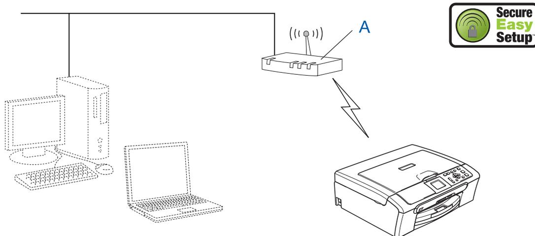
Se il punto di accesso senza fili (A) supporta SecureEasySetup™, non è necessario utilizzare un computer per configurare l'apparecchio. Il punto di accesso (router) e l'apparecchio possono negoziare automaticamente utilizzando la procedura SecureEasySetup™. Per le istruzioni, consultare pagina 23.
