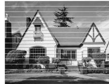
Lorsqu'une buse de tête d'impression est colmatée, voici à quoi ressemble la sortie imprimée.
