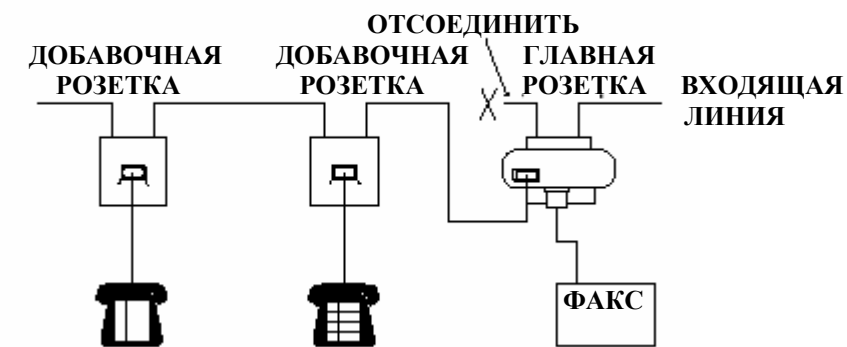
РЕКОМЕНДУЕМАЯ КОНФИГУРАЦИЯ СОЕДИНЕНИЙ ДОБАВОЧНЫХ ТЕЛЕФОННЫХ РОЗЕТОК
