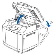
Снимите защитные элементы с обеих сторон блока термозакрепления тонера.
