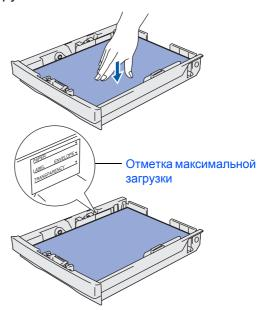
3адвиньте лоток для бумаги в устройство до упора.
