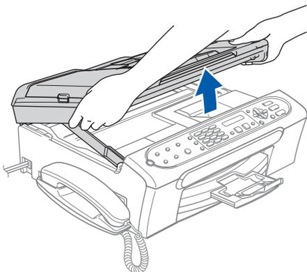
2 Insérez le câble USB dans la prise USB, marquée avec un symbole
