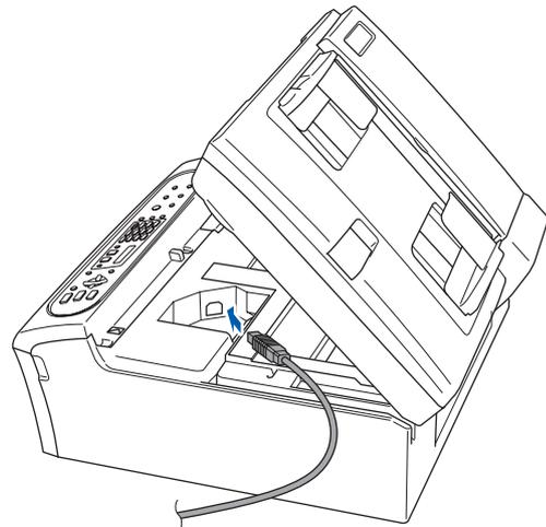
3 Faites passer soigneusement le câble USB à travers la tranchée et en dehors de l'arrière de l'appareil, comme illustré ci-dessous.
