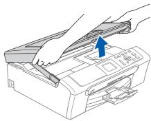
11 Conecte el cable USB a la conexión USB marcada con un símbolo ←. Encontrará la entrada de USB dentro del equipo, como se muestra en la ilustración.
