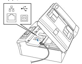
Inserte con cuidado el cable de red en la ranura, como se indica a continuación. pasando del círculo de ranura de conexión hacia la parte trasera del equipo. A continuación, conecte el cable a la red.
