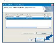
Si su equipo muestra **APIPA** en el campo **Dirección IP**, haga clic en **Configurar dirección IP** e introduzca una dirección IP para el equipo compatible con su red.
