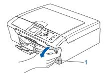
Tire de todas las palancas de desbloqueo del seguro inmovilizador hacia abajo y extraiga la pieza de protección amarilla (1).
