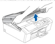
Conecte el cable de red a la conexión LAN marcada con el símbolo R. Encontrará la entrada LAN a la izquierda en el interior del equipo, como se muestra en la ilustración.
