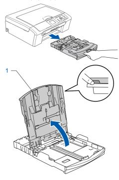
Pulse y deslice las guías laterales del papel (1) y la guía de longitud del papel (2) para que se adapte al tamaño del papel.
