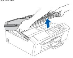
Conecte el cable de red a la conexión LAN marcada con el símbolo . Encontrará la entrada LAN a la izquierda en el interior del equipo, como se muestra en la ilustración.
