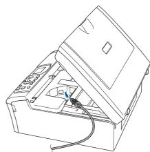
12 Inserte con cuidado el cable USB en la ranura, como se indica a continuación, pasando del círculo de ranura de conexión hacia la parte trasera del equipo. A continuación, conecte el cable al equipo.
