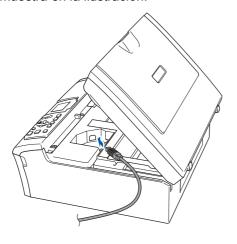
Inserte con cuidado el cable USB en la ranura, como se indica a continuación, pasando del círculo de ranura de conexión hacia la parte trasera del equipo.
