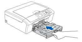
Mientras mantiene sujeta la bandeja de papel en ese lugar, extraiga el soporte de papel ① hasta que éste quede ajustado y, a continuación, despliegue la aleta de soporte del papel ②.
