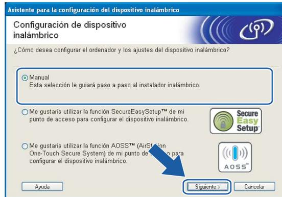
**7** Para realizar la configuración se recomienda que conecte temporalmente su dispositivo inalámbrico Brother directamente a un puerto libre en su punto de acceso, concentrador o enrutador empleando un cable de red.
