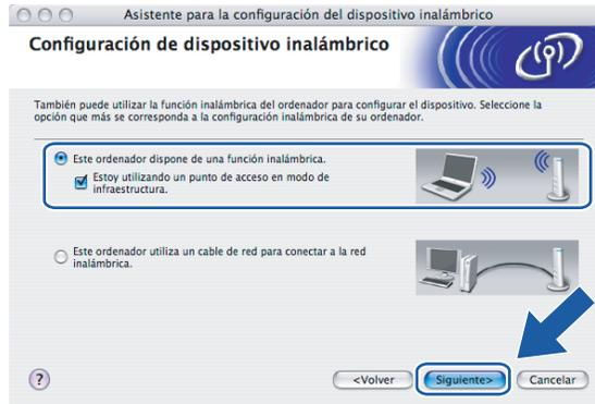
Si está utilizando un equipo cableado, seleccione **Este ordenador utiliza un cable de red para conectar a la red inalámbrica.** y ajuste la configuración inalámbrica en el panel de control. Haga clic en **Siguiente** y siga las instrucciones que aparecen en pantalla para terminar la instalación. Consulte *Uso del Asistente de configuración desde el panel de control* en la página 22.
