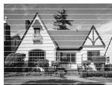
Si la boquilla del cabezal de impresión está obstruida, la prueba de impresión tendrá este aspecto.
