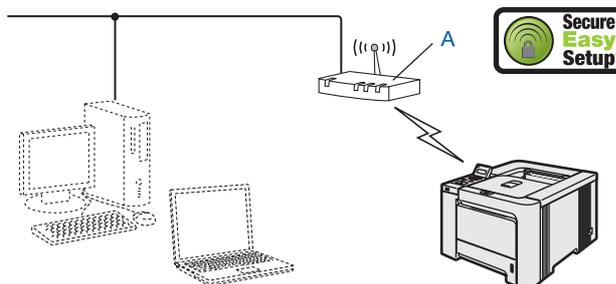
Se o seu ponto de acesso sem fios (A) suportar SecureEasySetup™, não precisa de utilizar um computador para configurar a impressora. O ponto de acesso (rotador) e a impressora podem negociar automaticamente utilizando o procedimento SecureEasySetup™.
