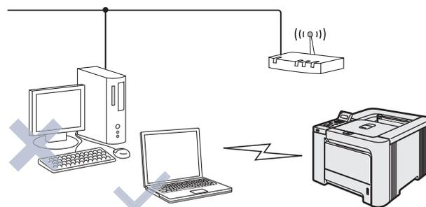
Se o seu computador tiver capacidade para redes sem fios, terá de alterar as definições de rede sem fios do computador para o modo Ad-hoc, de forma a poder ligar directamente a impressora e configurá-la. Para obter instruções, consulte *Configuração no modo de Infra-estrutura, com um computador sem fios* na página 34.
