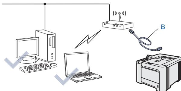
Se houver um hub ou rotador Ethernet na mesma rede que o ponto de acesso do seu computador, pode ligar temporariamente o hub ou o rotador à impressora utilizando um cabo Ethernet (B), sendo uma maneira fácil de configurar a impressora. Pode então configurar remotamente a impressora a partir de um computador da rede. Para obter instruções, consulte *Instalação no modo de Infra-estrutura, com um cabo de rede temporário*, na página 49.
