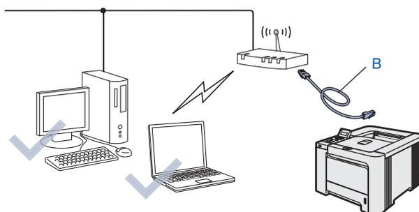
Se houver um hub ou router Ethernet na mesma rede que o ponto de acesso do seu computador, pode ligar temporariamente o hub ou o router à impressora utilizando um cabo Ethernet(B), sendo uma maneira fácil de configurar a impressora. Pode então configurar remotamente a impressora a partir de um computador da rede. Para obter instruções, consulte *Instalação no modo de Infra-estrutura, com um cabo de rede temporário*, na página 30.
