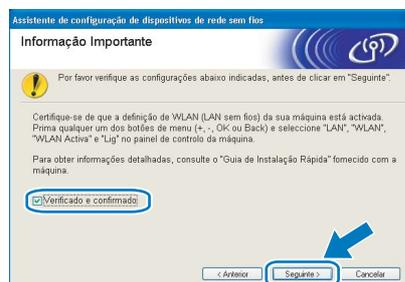
**9** Tem de alterar temporariamente as definições de rede sem fios do seu computador. Siga as instruções que aparecem no ecrã. Certifique-se de que toma nota de todas as definições, como o SSID ou o canal do seu computador. Precisarás delas para repor as definições de rede sem fios de origem do seu computador; em seguida clique em **Seguinte**.
