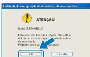
**14** Se a sua rede estiver configurada para Autenticação e Encriptação, será apresentado o seguinte ecrã. Ao configurar a impressora sem fios Brother, tem de garantir que o faz de forma a corresponder às definições de Autenticação e de Encriptação da rede sem fios já existente. Escolha o **Método de autenticação** e o **Modo de encriptação** a partir dos menus pendentes de cada caixa de definição. Em seguida, introduza a **Chave de rede** e clique em **Seguinte**.
