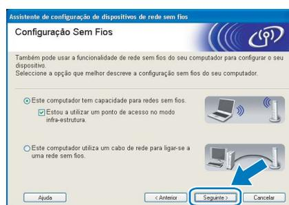
Se estiver a utilizar um computador com fios, escolha **Este computador utiliza um cabo de rede para ligar-se a uma rede sem fios.** e terá de configurar as definições de rede sem fios a partir do painel de controlo. Clique em **Seguinte** e consulte o Capítulo 3 do Manual do utilizador de rede incluído no CD-ROM, para obter instruções. Se já tiver concluído as definições de rede sem fios, clique em **Seguinte** e vá para 8.
