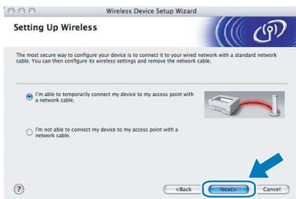
**7** Para proceder à configuração, tem de ligar temporariamente o dispositivo sem fios Brother (a sua impressora) directamente a uma porta livre do ponto de acesso, hub ou router, utilizando um cabo de rede. Quando o ecrã que se segue aparecer, ligue o cabo de rede ao ponto de acesso e, em seguida, à impressora. Clique em **Next** (Seguinte).
