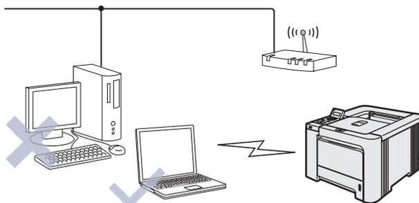
Se o seu computador tiver capacidade para redes sem fios, terá de alterar as definições de rede sem fios do computador para o modo Ad-hoc, de forma a poder ligar directamente a impressora e configurá-la. Para obter instruções, consulte *Instalação no modo de Infra-estrutura, com um cabo de rede temporário*, na página 49.
