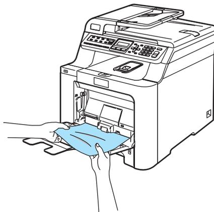
3 Feche a bandeja MP. Em seguida, abra a tampa da frente e volte a fechá-la para reiniciar o aparelho. Abra novamente a bandeja MP.
