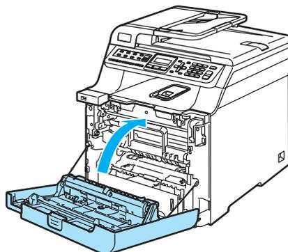
Lorsque vous remplacez la courroie, vous devez remettre à zéro le compteur de courroie en suivant les étapes suivantes :
