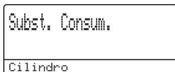
O aparelho usa uma unidade de cilindro para criar as imagens impressas no papel. Se o display mostrar a mensagem *Subst. Consum. Cilindro*, a unidade do cilindro está chegando ao fim de sua vida útil e é hora de comprar uma nova.
