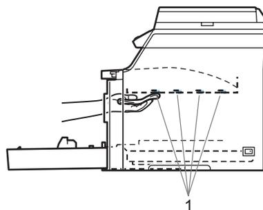
**6** Установите блок фотобарабана на место следующим образом.
