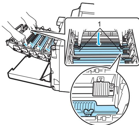
**2** Очистите коронирующий провод внутри блока фотобарабана, осторожно переместив синий ползунок несколько раз справа налево и слева направо.
