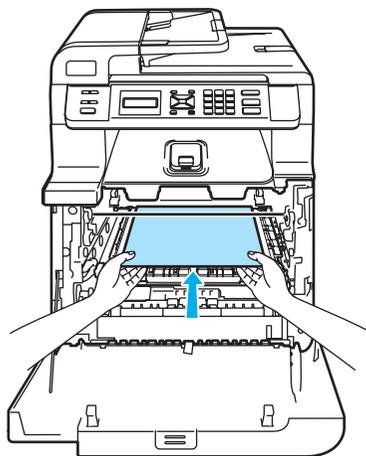
**12** Установите блок фотобарабана на место следующим образом.
