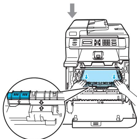
**8** Установите блок фотобарабана на место следующим образом.
