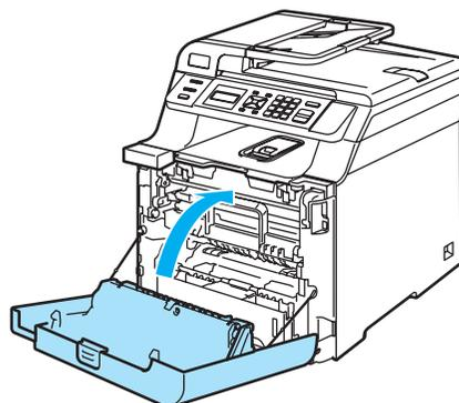
При установке нового фотобарабана необходимо переустановить счетчик блока фотобарабана, выполнив следующие действия.
