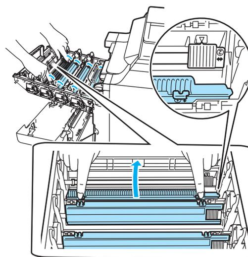
8 Повторите пункты с 5 до 7 для очистки каждого из оставшихся коронирующих проводов. Всего имеется четыре коронирующих провода.
