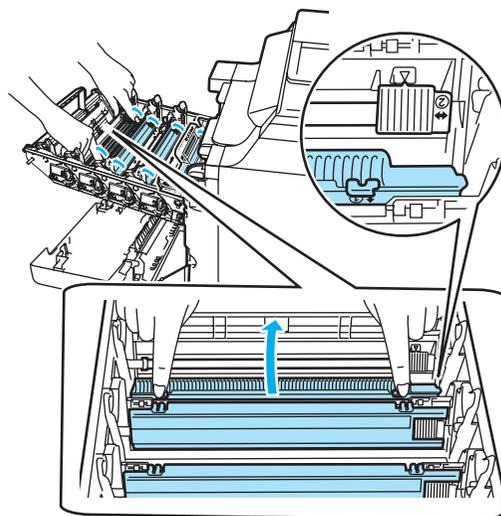
**4** Повторите пункты с 1 до 3 для очистки остальных трех коронирующих проводов.
