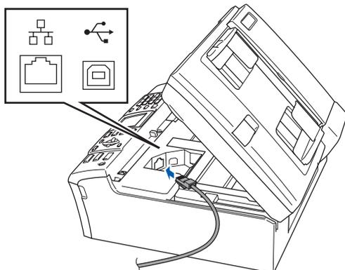
**4** Passe cuidadosamente o cabo de rede através da calha, como indica a figura, posicionando a calha à volta e para a parte de trás do aparelho.
