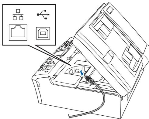
**12** Guidez soigneusement le câble USB dans la rainure comme indiqué ci-dessous, en suivant celle-ci autour et vers l'arrière de l'appareil. Connectez ensuite le câble à l'ordinateur.
