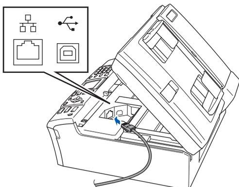
**4** Guidez soigneusement le câble réseau dans la rainure comme indiqué ci-dessous, en suivant celle-ci autour et vers l'arrière de l'appareil. Connectez ensuite le câble à votre réseau.
