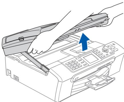
**3** Reliez le câble réseau à la prise LAN repérée par le symbole
