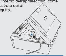
C. Inserire accuratamente il cavo USB nella canalina come mostrato di seguito, disponendo il cavo intorno e verso il lato posteriore dell'apparecchio.
