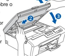
c. Passe cuidadosamente o cabo USB através da calha, como indica a figura, posicionando a calha à volta e para a parte de trás do aparelho.
