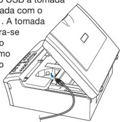
c. Guie o cabo USB cuidadosamente para dentro do canal do cabo e através da parte traseira do aparelho. Ligue o cabo ao computador.
