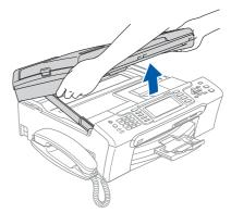
11 将USB电缆插入带有还标志的USB插口中。如下图所示,USB插口位于打印机内部右侧。
