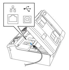
12 如下图所示,小心地将 USB 接口电缆 嵌入槽内,并顺着槽绕到设备后部。然 后连接电缆与计算机。
