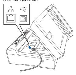
4 如下图所示,小心地将 USB 接口电缆 嵌入槽内,并顺着槽绕到设备后部。然 后将电缆连接到网络。
