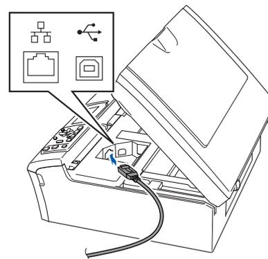
**4** Führen Sie das Kabel - wie gezeigt - vorsichtig durch die Vertiefung zur Rückseite des Gerätes. Schließen Sie das Kabel dann an Ihrem Netzwerk an.
