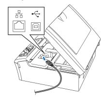
Inserire accuratamente il cavo di rete nella canalina come mostrato di seguito, disponendo il cavo intorno e verso il lato posteriore dell'apparecchio.
