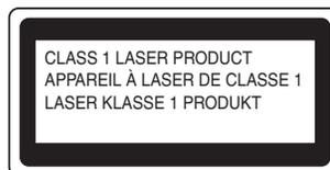
Данный принтер оснащен лазерным диодом класса 3В, который является источником невидимого лазерного излучения в блоке лазера. Ни при каких обстоятельствах не открывайте крышку блока лазера.
