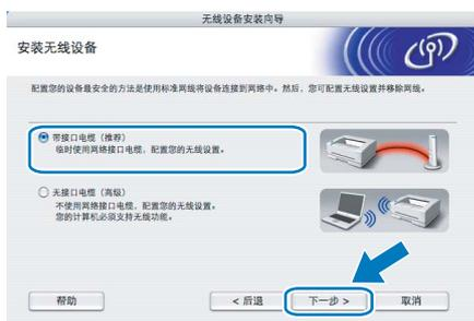
**9** 为进行配置，必须使用网络电缆临时将 Brother 无线设备 (本打印机) 连接至接入点、集线器或路由器的闲置端口。出现下列窗口时，将网络电缆插入接入点和打印机。点击“下一步”。
