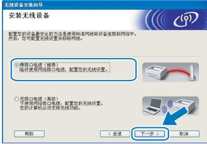
**9** 为进行配置，必须使用网络电缆临时将 Brother 无线设备(本打印机)直接连接至接入点、集线器或路由器的闲置端口。出现下列窗口时，将网络电缆插入接入点和打印机。点击“下一步”。
